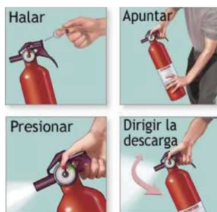
Figura 73 Capacitación en el uso del extintor.
