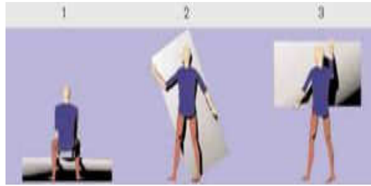
Figura 66 Levantamiento con tres puntos de apoyo
