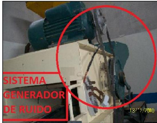
**Figura 30: Ruido generado por motores eléctricos y sistema de transmisión.**
