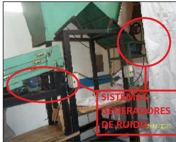
**Figura 43: Ruido causado por motores eléctricos en la máquina de insuflado.**
