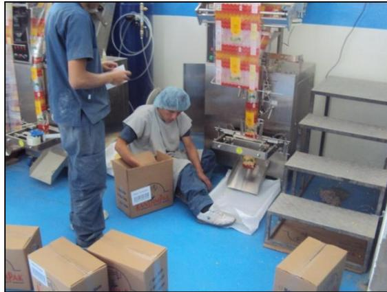
**Figura 40: Colocación en cajas del material automáticamente empacado.**
