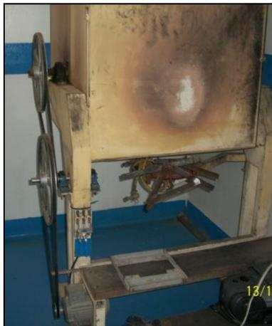
**Figura 23: Elementos de transmisión desprotegidos.**
