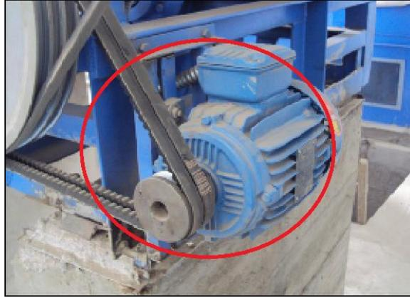
**Figura 78: Generador de ruido en el área de selección por criba.**
