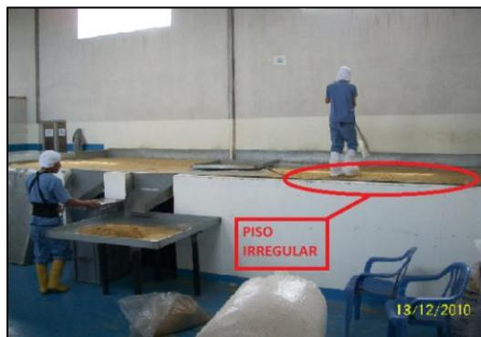
**Figura 62: Piso irregular (resbaladizo) en la secadora.**
