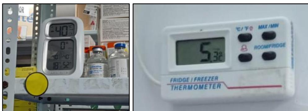
**Figura 6-3:** Termohigrómetro de la farmacia y termómetro usado para cadena de frío.
