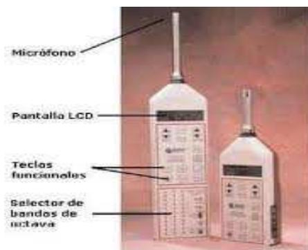
**Figura 4.2.1.1.a:** Sonómetro marca QUEST<sup>4</sup>
