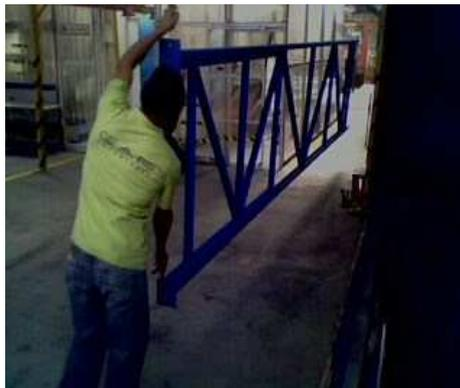
**Figura 3.3.8.3.a:** Traslado de escalerilla de la cabina de pintura al Horno
