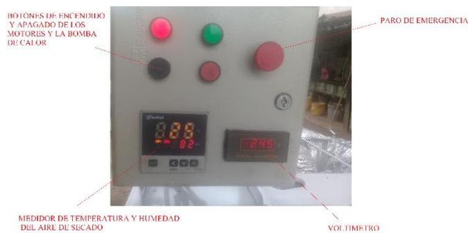
**Figura 2-4:** Tablero de accionamiento de la maquina
