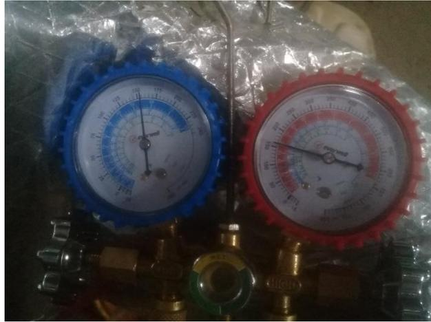
**Figura 5-4:** Medidor de presión del refrigerante de la bomba de calor
