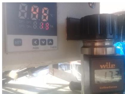
**Figura 6-4:** Medidor de humedad de los granos de cacao.
