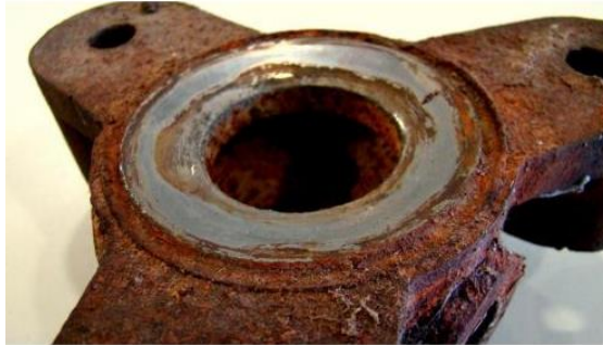
Figura 4-2. Elemento de máquina atacado por el desgaste corrosivo.
