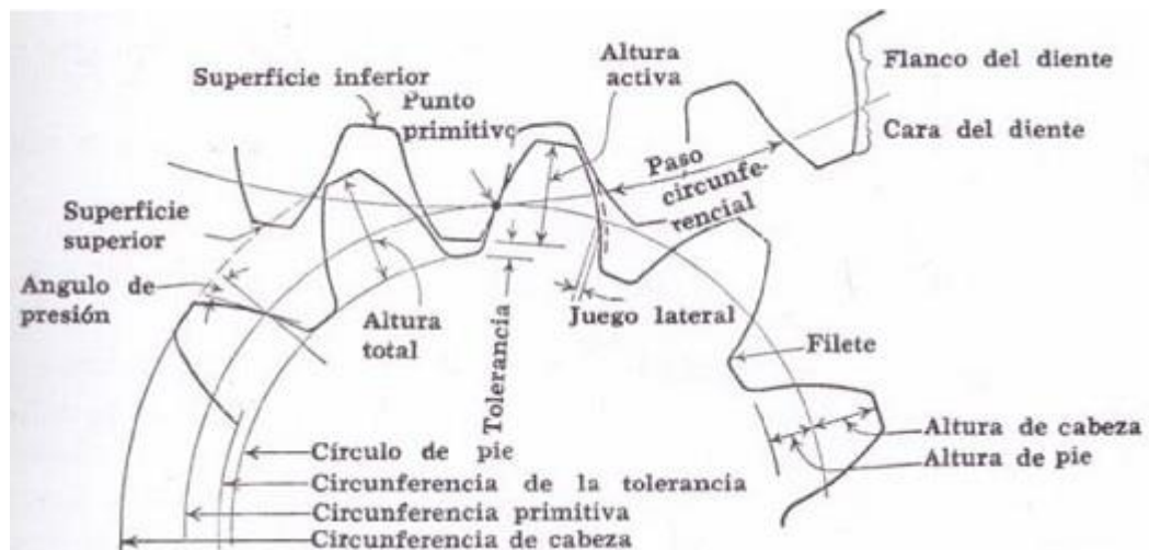
Figura 24-2. Terminología engranajes helicoidales.
