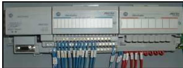
**Figura II.17. Sistema de Entradas y Salidas de un PLC**
