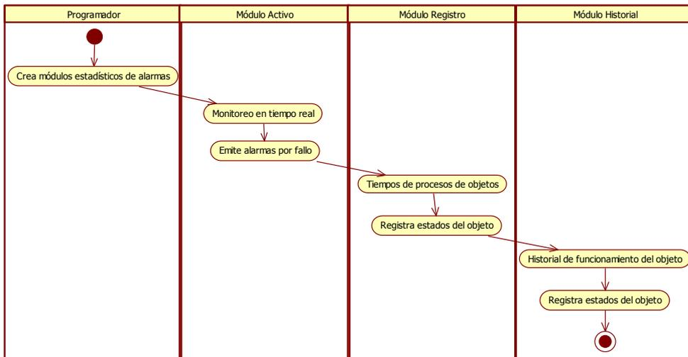
Figura IV.69. DA: Programación del Registro de Alarmas
