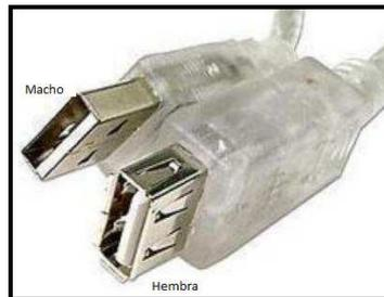
**Figura II.33. Conector USB Tipo A**
