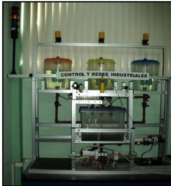
**Figura IV.80. Módulo de Mezclado de Líquidos**
