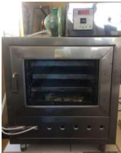
**Figura 3-4. Secado de diáfisis en estufa a 98 °C**
