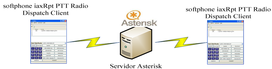
Figura III - 45 Llamada desde softphoneiaxRpt PTT Radio DispatchClient a otro softphoneiaxRpt PTT Radio DispatchClient con protocolo IAX2
