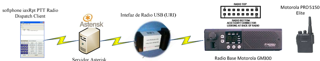
Figura III - 43 Llamada desde softphoneiaxRpt PTT Radio DispatchClient con protocolo IAX2 a la estación portátil Motorola pro 5150 elite
