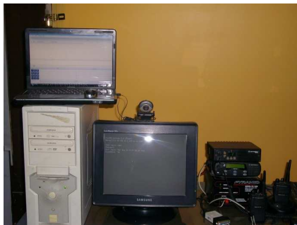
Figura III - 40 Comunicación entre una estación portátil Motorola Pro 5150 elite con la central Asterisk
