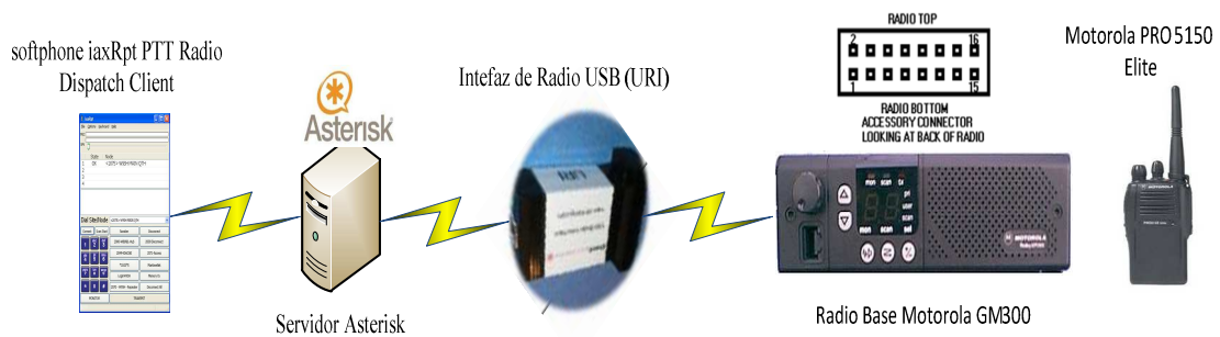
Figura III - 24 Diagrama de la solución del sistema de radio frecuencias con VoIP
