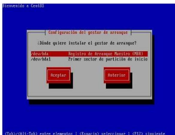
Figura IV - 58 Partición para instalar el gestor de arranque
