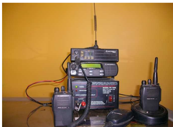
Figura III - 32 Comunicación entre Motorola GM300 con estaciones portátiles
