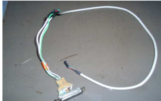
Figura III - 36Cable DB25 para conectar la tarjeta URI con la radio base Motorola GM300
