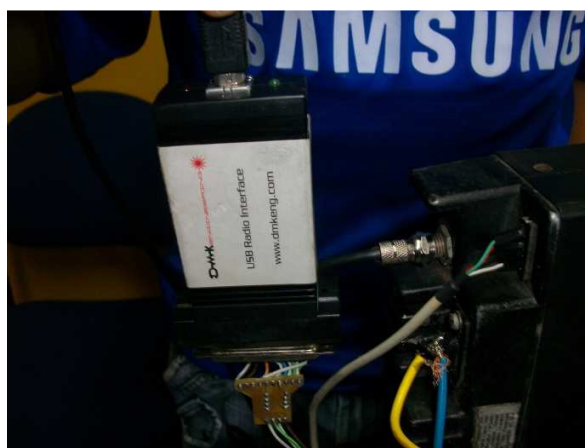
Figura III - 35 Comunicación entre Motorola GM300 con interfaz URI
