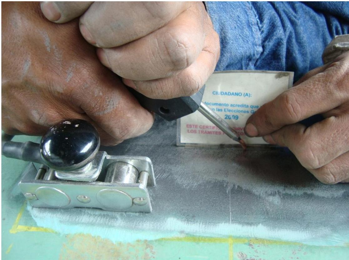
Fig. 12. Colocación del strain gauge
