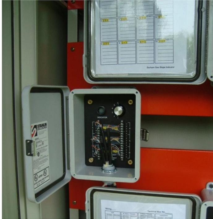
Fig. 21. Conexión del strain gauge a la caja de control
