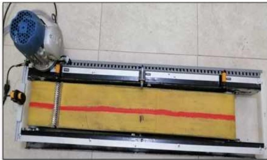
Figura 16-3: Estructura banda transportadora
