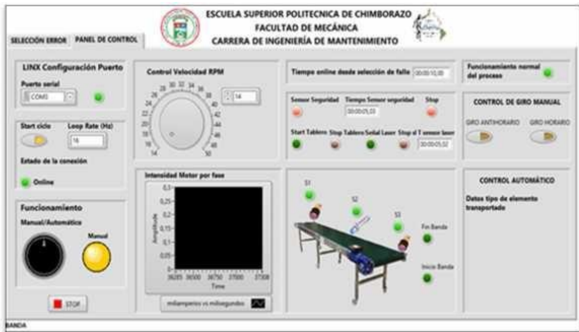
Figura 39-3: Vista panel frontal VI módulo diagnóstico de fallos
