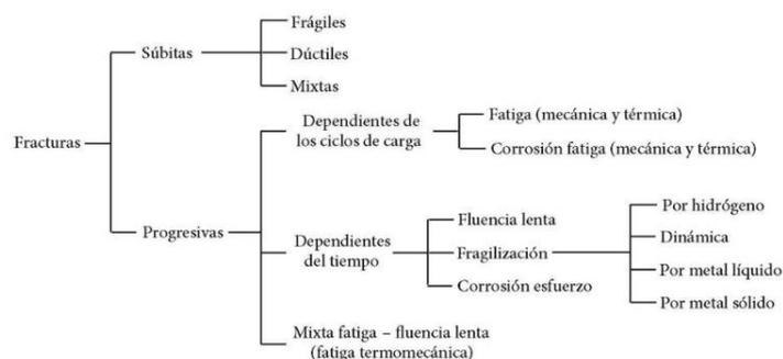
**Figura 39-2.** Clasificación de los modos de falla por fractura más comunes en metales, de acuerdo con su naturaleza súbita o progresiva.
