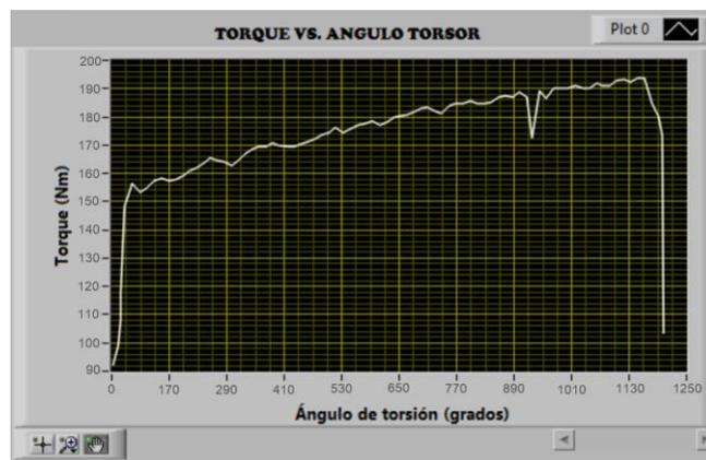
**Gráfico 35-3.** Gráfico de la probeta A473\_T02: Torque (Nm) versus ángulo de torsión (grados)
