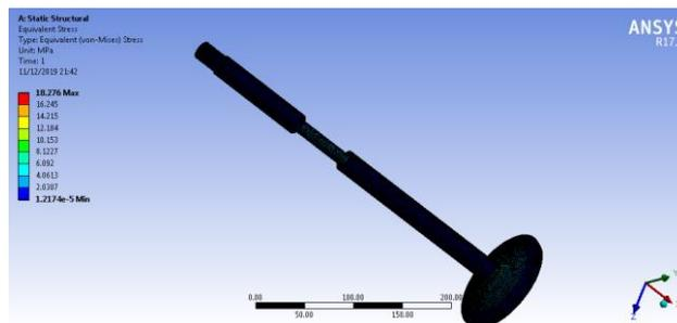
**Figura 11-3.** Esfuerzo equivalente de Von Mises
