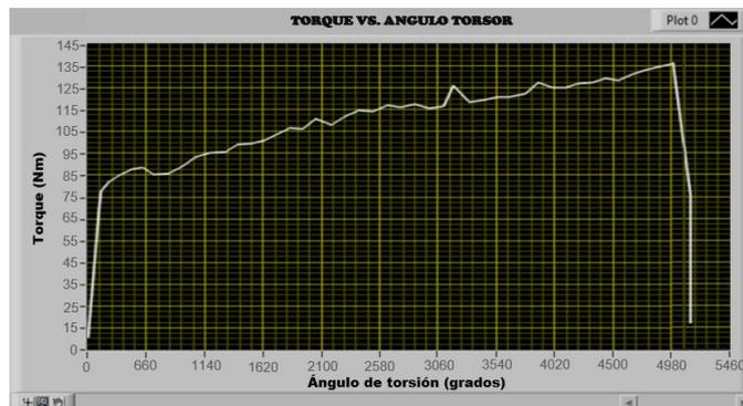
**Gráfico 32-3:** Gráfico de la probeta AISI 1018\_T02: Torque (Nm) versus ángulo de torsión (grados)
