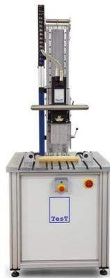
**Figura 8-2.** Máquina de torsión vertical
