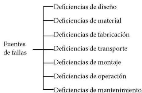
**Figura 37-2.** Fuentes de falla básicas de los elementos mecánicos y estructuras
