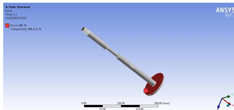
**Figura 9-3.** Aplicación de fuerzas en la barra de carga
