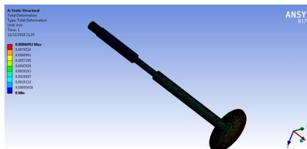
**Figura 12-3.** Deformación máxima en la barra de carga
