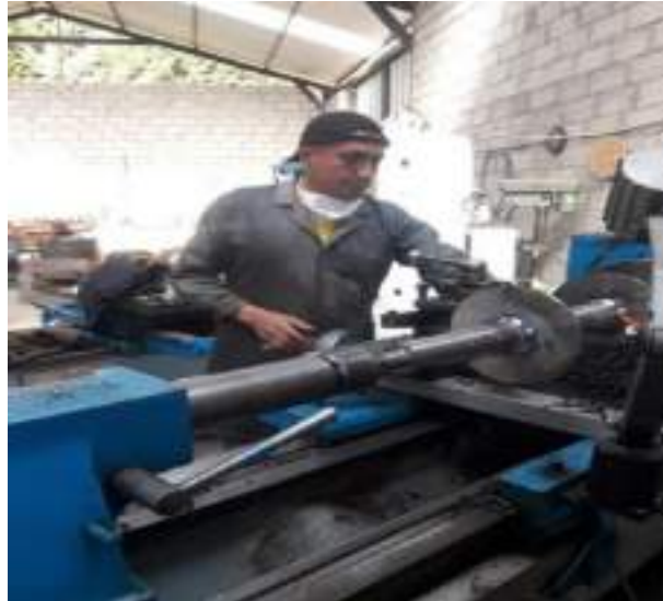
Figura 3-71: Construcción del eje de la máquina
