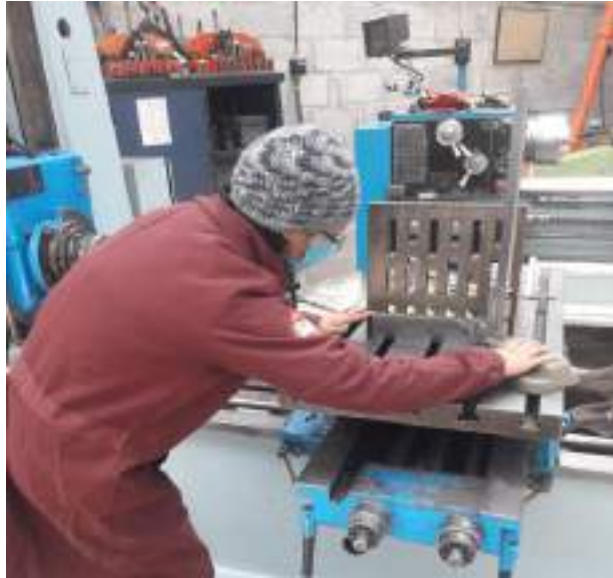
Figura 3-73: Revisión de tolerancias en la cuchilla.
