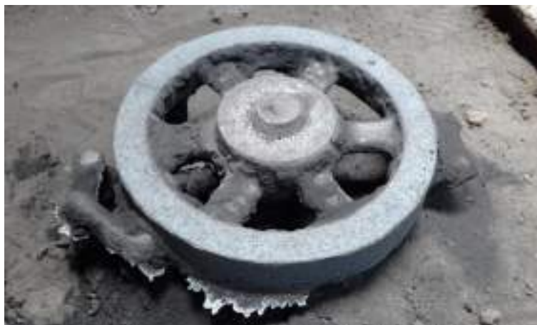
Figura 3-78: Fundición del volante de inercia.
