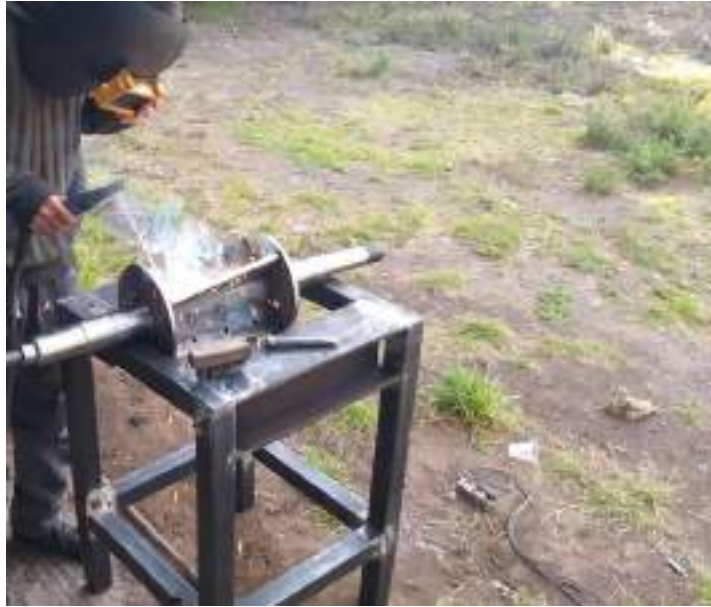
Figura 3-75: Colocación de las porta cuchillas sobre el eje.
