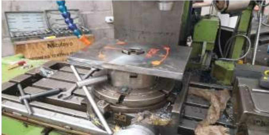
Figura 3-81: Construcción de las placas laterales del bastidor.
