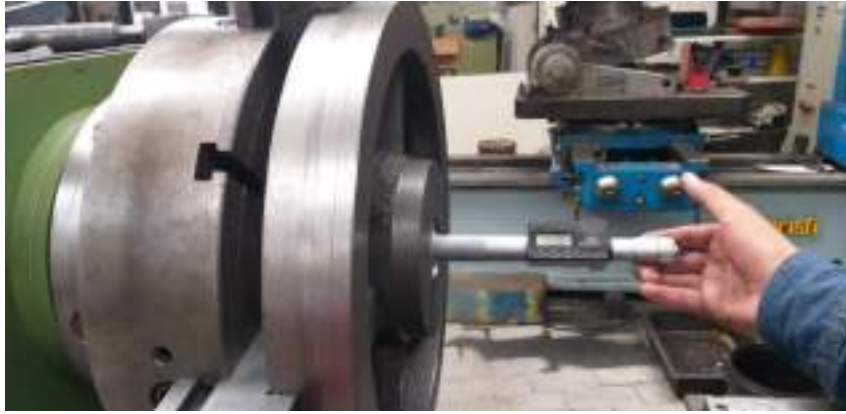
Figura 3-79: Rectificado del volante de inercia
