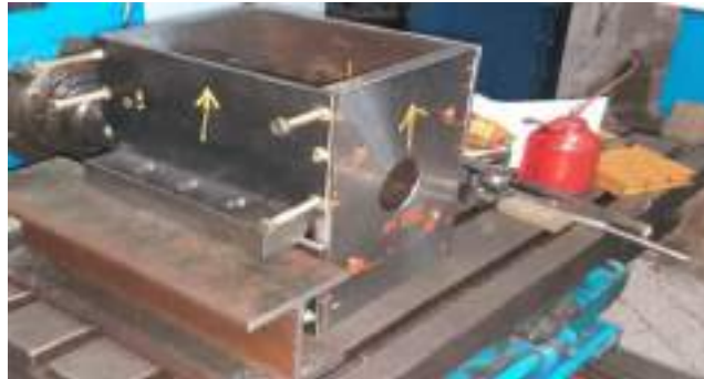
Figura 3-88: Junta de placas laterales desmontable
