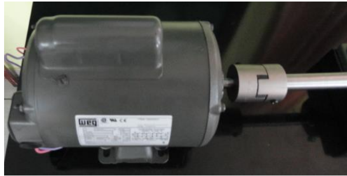
Figura 19-4: Montaje del motor en el eje de motriz.
