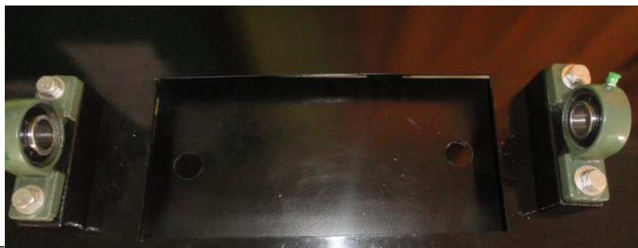
Figura 15-4: Montaje de las placas y chumaceras.
