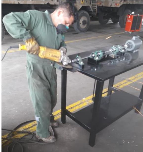
Figura 24-4: Acabado de los elementos mecánicos.
