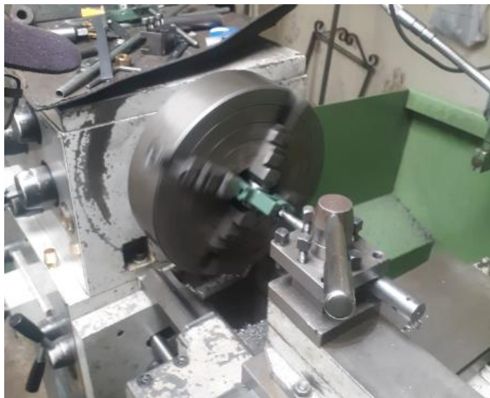
Figura 6-4: Torneado y roscado de chumaceras de presión.
