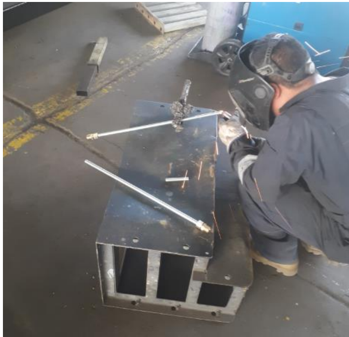
Figura 7-4: Proceso de soldadura MIG en porta pesas.
