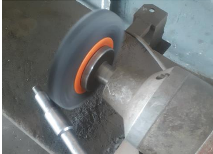
Figura 3-4: Cepillado de los ejes luego del proceso de torneado.
