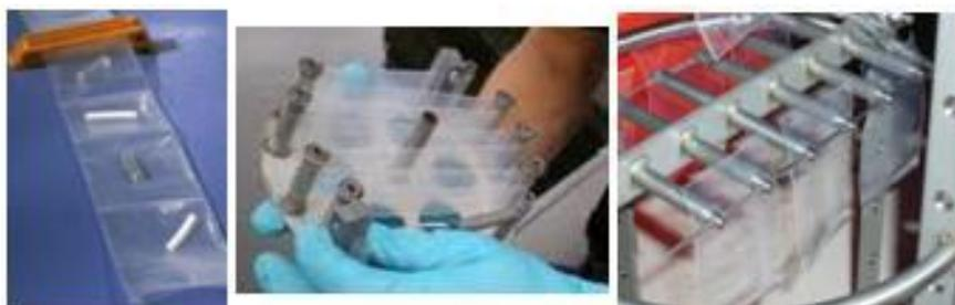
**Figura 2-2:** Distintos muestreadores pasivos para compuestos no-polares.
