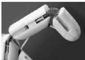
Figura 24-2. Sistema basado en tendones con muelles de escape en articulaciones Fuente: (Ayats Soler, 2017)
