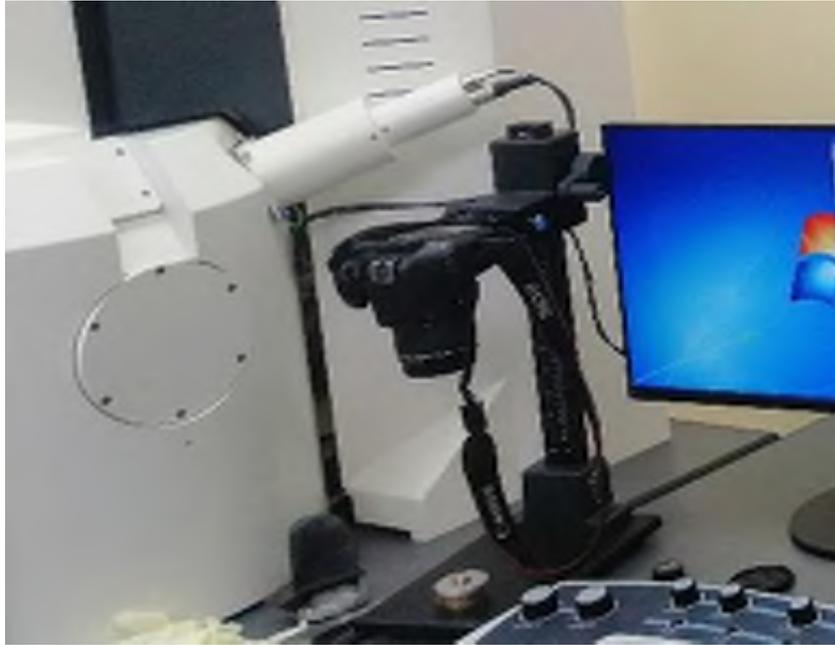
**Figura 2-5:** Cámara CANON EOS Réflex sujeta en torreta de laboratorio de análisis de fallas.
