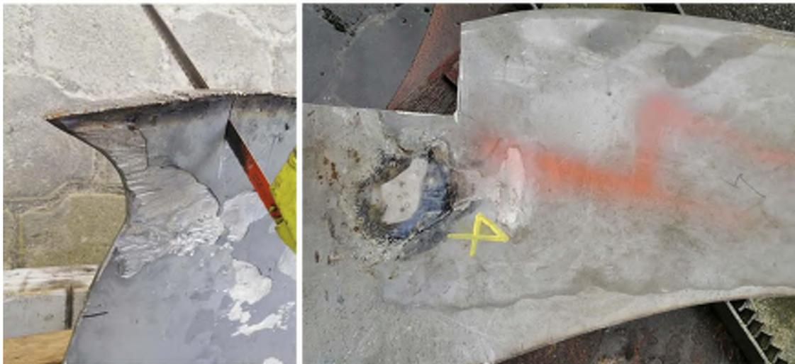
**Figura 2-2:** Obtención de la probeta principal al cortar el álabe número 4.
