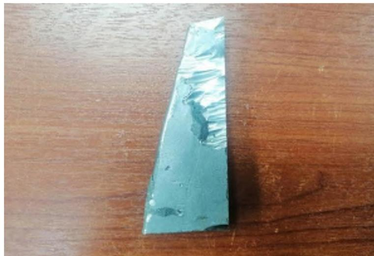
**Figura 2-3:** Probeta obtenida mediante corte manual para el análisis en SEM.
