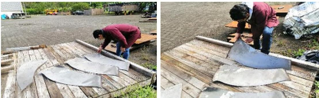
**Figura 2-1:** Inspección de daños en los álabes del rodete de la unidad 1 de San Francisco.
