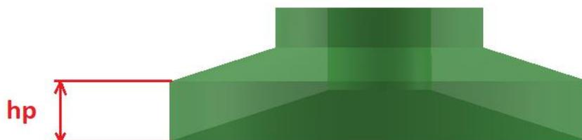
**Figura 13-4:** Vista lateral del volumen de control de la zona primaria del difusor.
