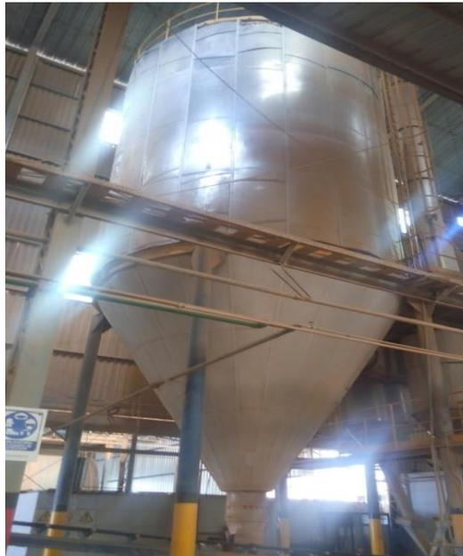
**Figura 1-2:** Atomizador SACMI ATM-15 de la empresa
