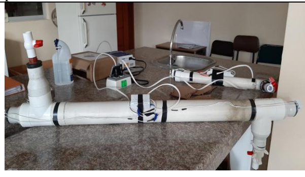
Fotografía 28: Reactores UV de 40 y 20 watts
