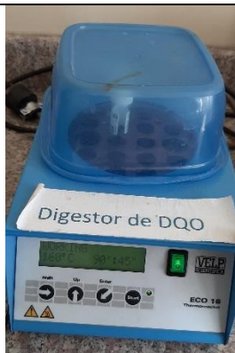
Fotografía 21: Digestión de la muestra para medir DQO
