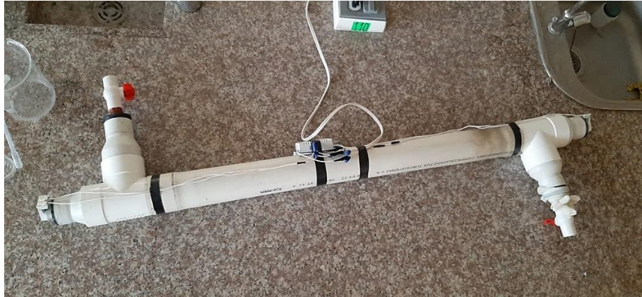
Figura 4-2: Reactor UV con lámpara de 40 watts
