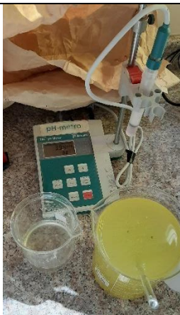
Fotografía 13: Ajuste de pH utilizando H_2SO_4 1N
