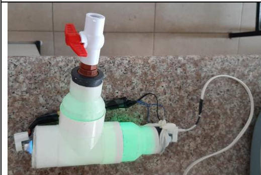
Fotografía 27: Reactor UV de 10 watts
