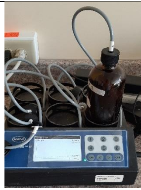
Fotografía 24: Medición de DBO
