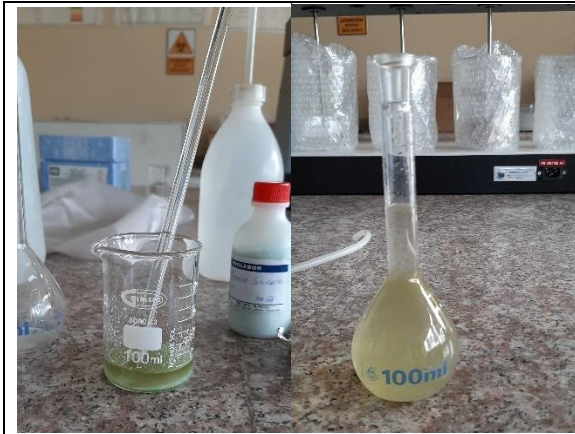
Fotografía 5: Preparación de la solución madre de \text{FeSO}_4
