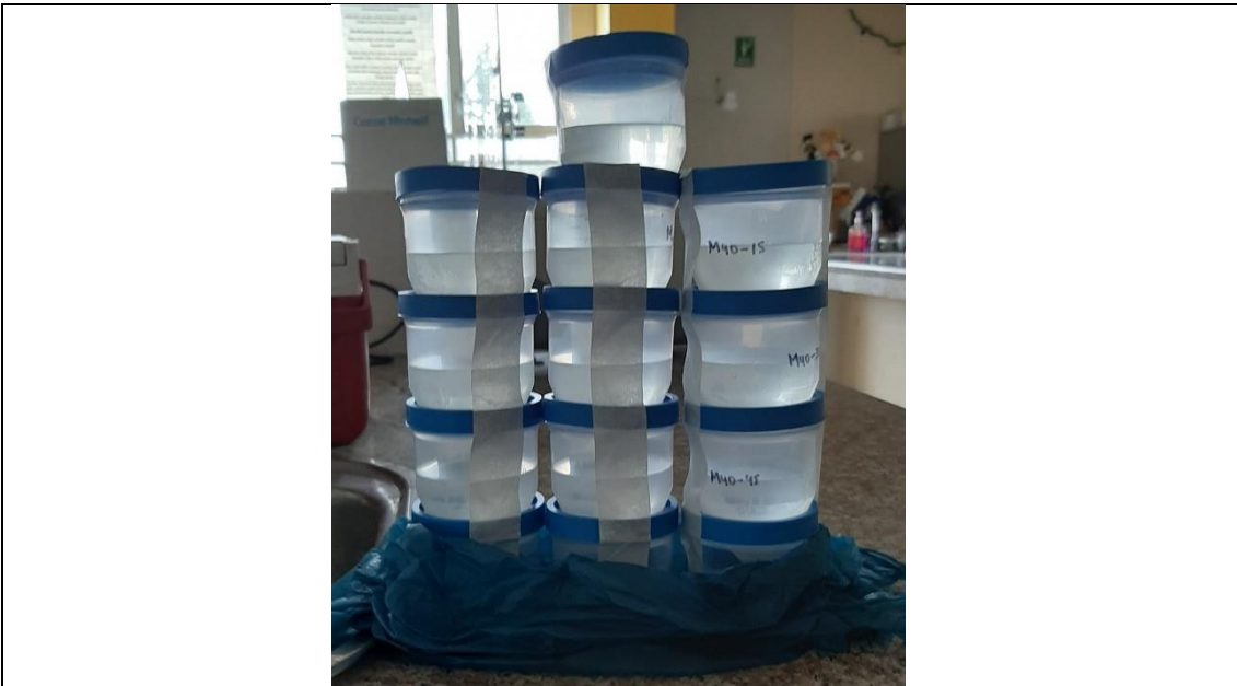
Fotografía 29: Toma de muestras del agua tratada mediante foto-fenton para el análisis de coliformes fecales
