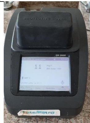
Fotografía 22: Medición de DQO en el fotómetro
