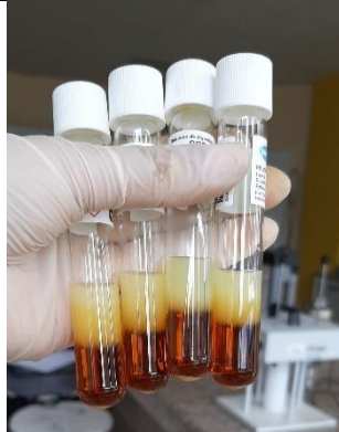
Fotografía 20: Preparación de muestras para medir DQO
