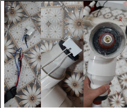
Fotografía 25: Construcción de los reactores UV
