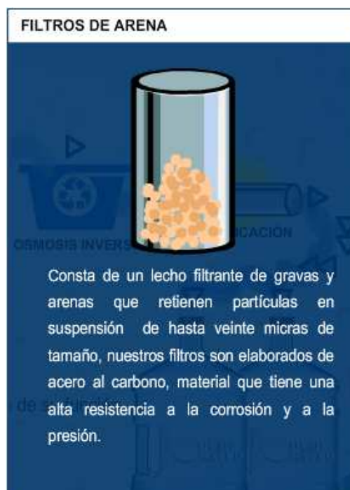
Figura 4: Filtros de arena
