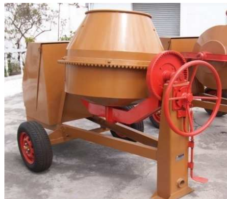
Figura 16. CONCRETERA SACO Y MEDIO
