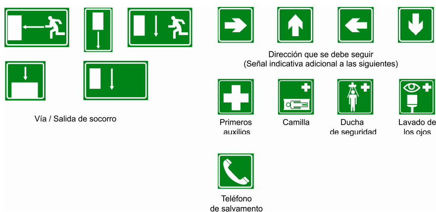
Fig. 97: Señales de salvamento o socorro.
