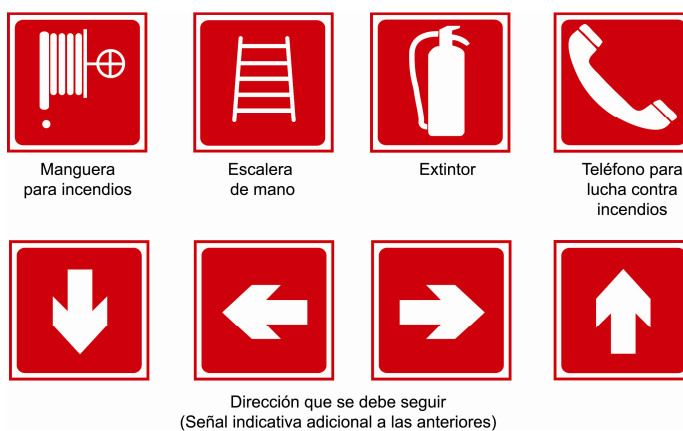
Fig. 96: Señales relativas a los equipos de lucha contra incendios.
