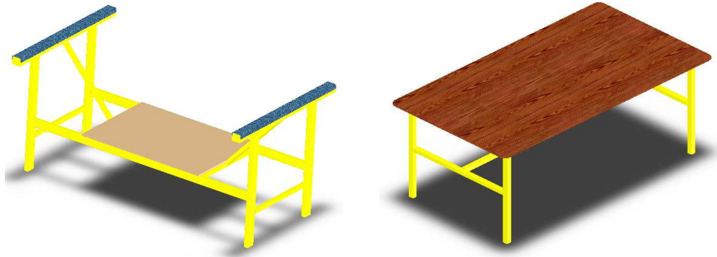
Figura 27: Mesa de acabados para puertas y tapa del motor
