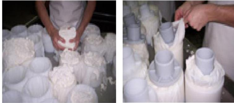
**Figura 4-3.** Introduciendo cuajo en molde. Moldes listos para prensar
