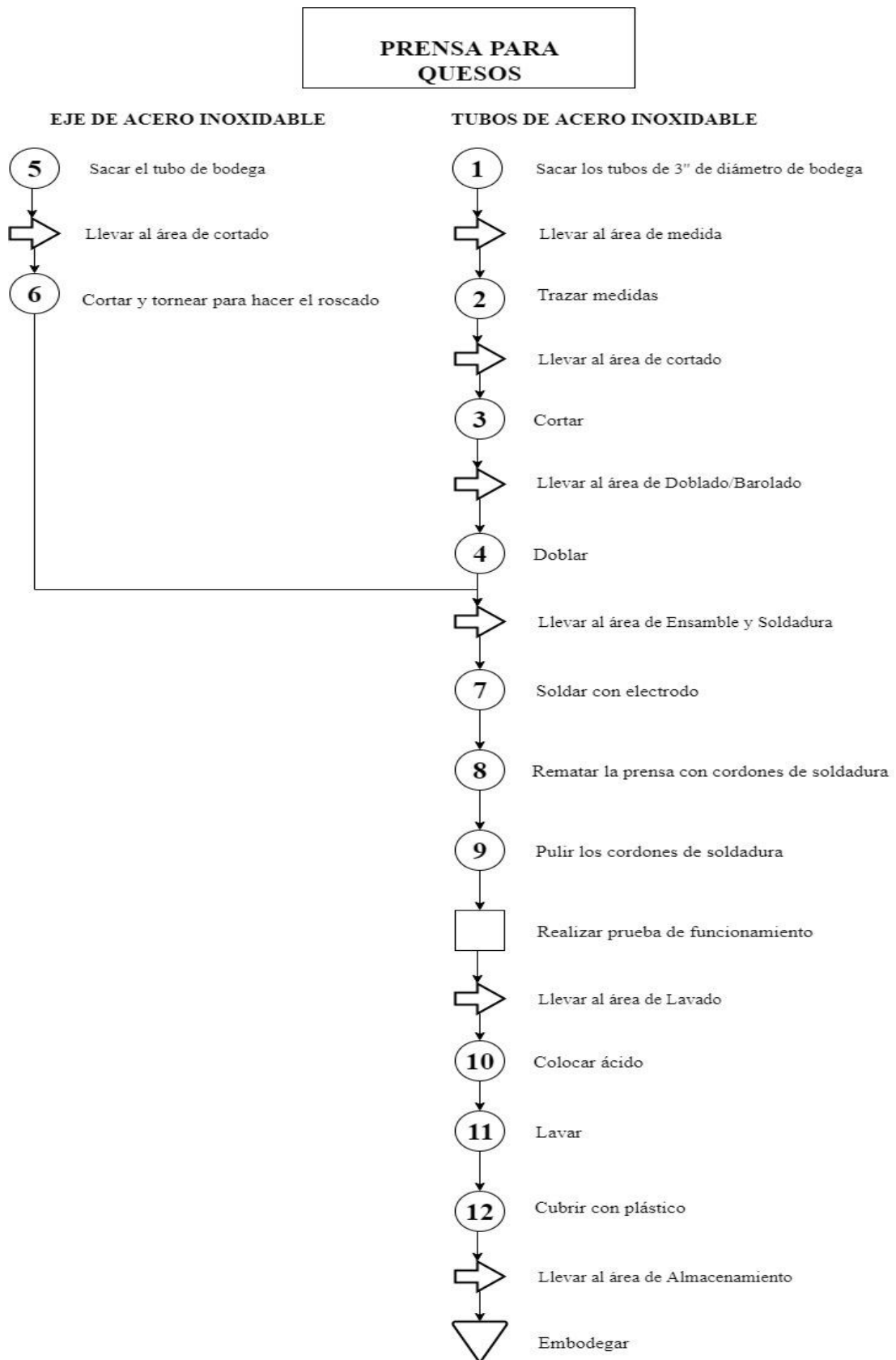
Gráfico 25-3:. Diagrama de Proceso de la Prensa para Quesos Elaborado por: Jácome, K. 2020
