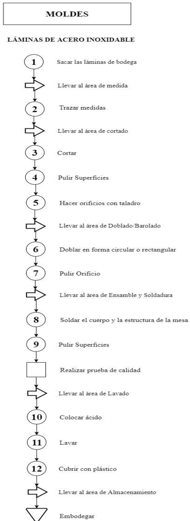
Gráfico 233-3: Diagrama de Proceso de los Moldes para Quesos Elaborado por: Jácome, K. 2020
