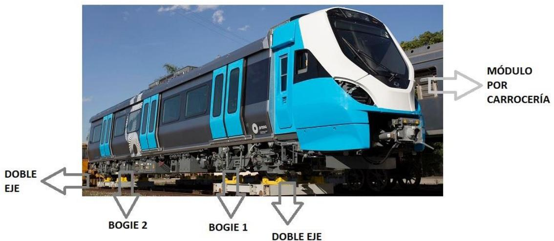
**Figura 14-3:** Partes material rodante
