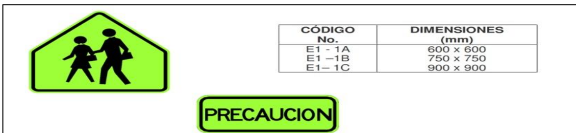
Figura 13-1: Señalización vertical informativa de aproximación a zona escolar
