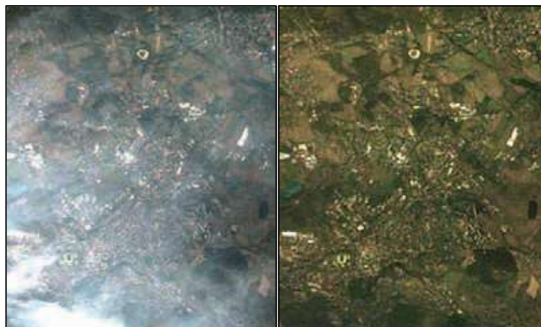
Figura 9. Imagen original captada por el satélite (izquierda). Imagen corregida del efecto atmosférico (derecha).
