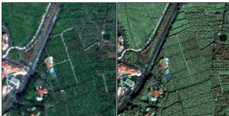
Figura 7. Imágenes con distinta resolución espacial: 2 m/píxel (izquierda) frente a 0,5 m/píxel(derecha)
