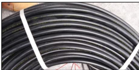
Figura 10-3. Manguera de descarga del sistema por recirculación
