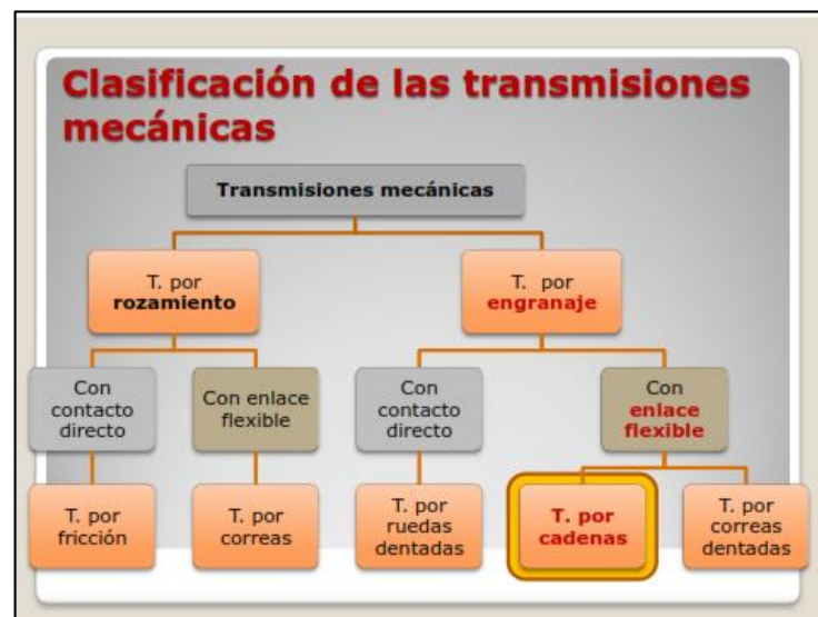
Figura 4-2. Clasificación de las Transmisiones mecánicas
