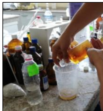
Figura 6-3. Medición de oxígeno disuelto por método químico
