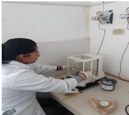
**Figura 33-2:** Preparación de submuestras para ser colocadas en un crisol.
