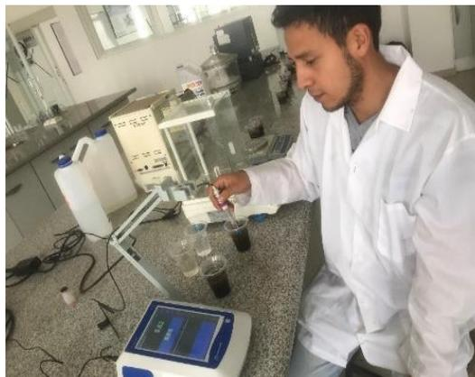
**Figura 23-2:** Medición de pH de las muestras
