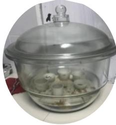
**Figura 13-2:** Crisoles en un Desecador
