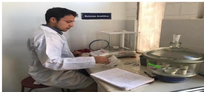
**Figura 30-2:** Crisoles con las muestras pesados en la balanza analítica.
