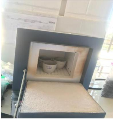
**Figura 31-2:** Calcinación de los crisoles con las muestras.
