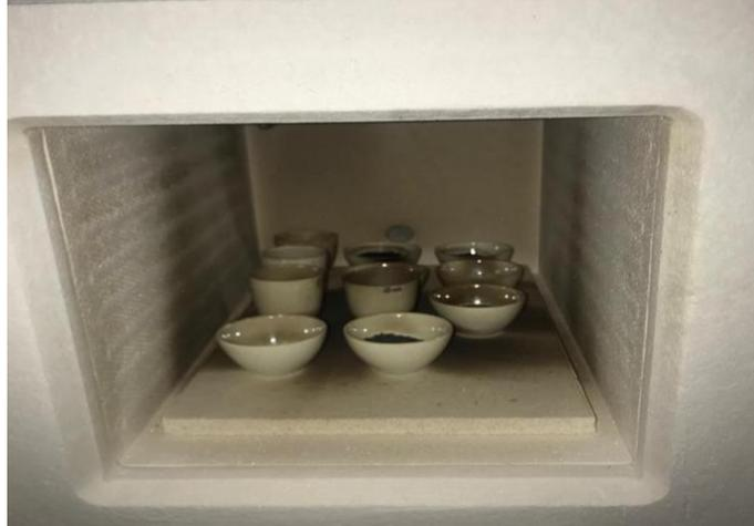
**Figura 34-2:** Calcinación de las muestras a 450°C por 4 horas
