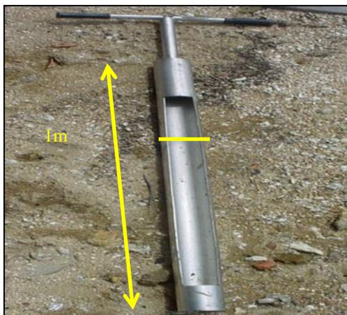
**Figura 2-2:** Muestreadores especialmente diseñados para suelos y sedimentos de manglar.
