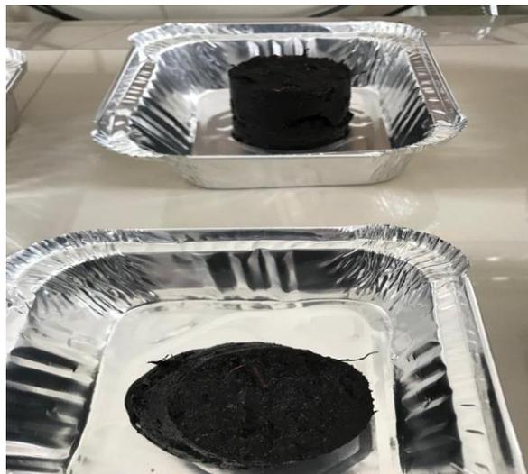
**Figura 27-2:** Determinación de densidad aparente
