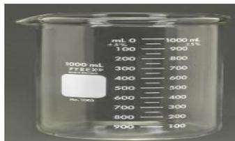
**Figura 12-2:** Vaso de precipitación de 1000 mL.
