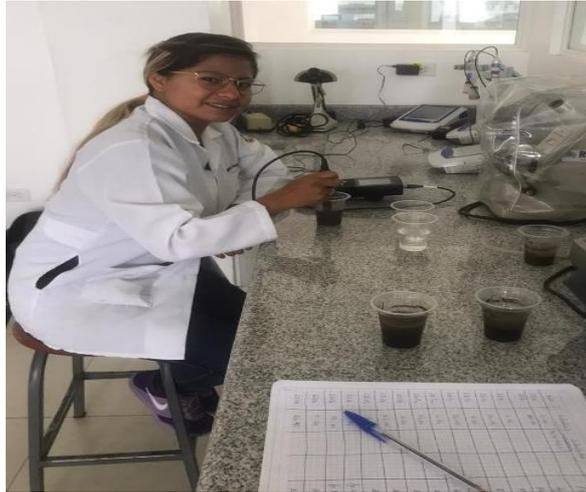
**Figura 25-2:** Medición de conductividad eléctrica en las muestras.
