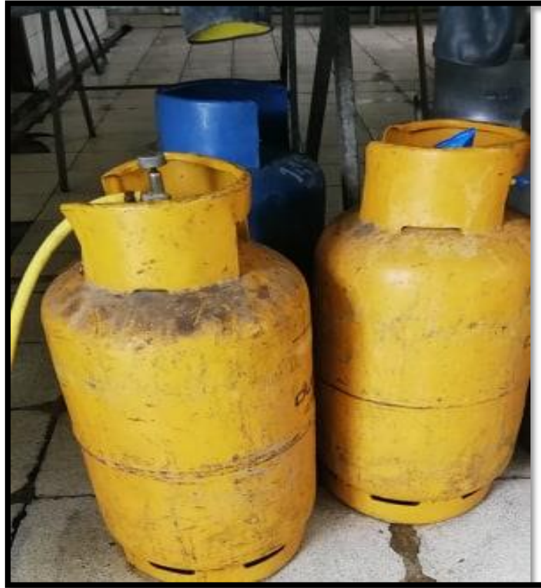
Imagen 11: Presencia de material inflamable en el área de producción.
