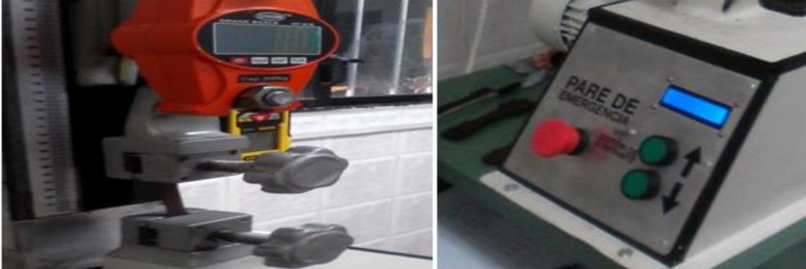
**Fotografía 1-2:** Equipo para la medición de la resistencia a la tensión del cuero.
