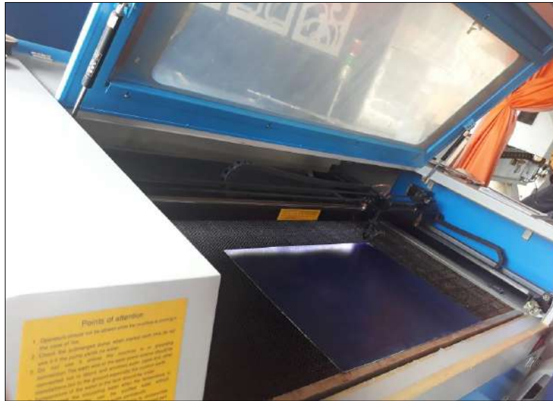
Fotografía 6-3: Corte de probetas mediante láser CNC
