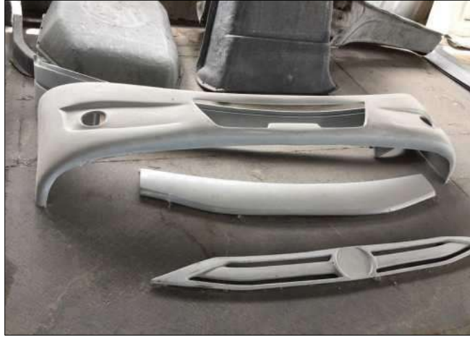
Fotografía 1-3: Guardachoque elaborado por laminación manual
