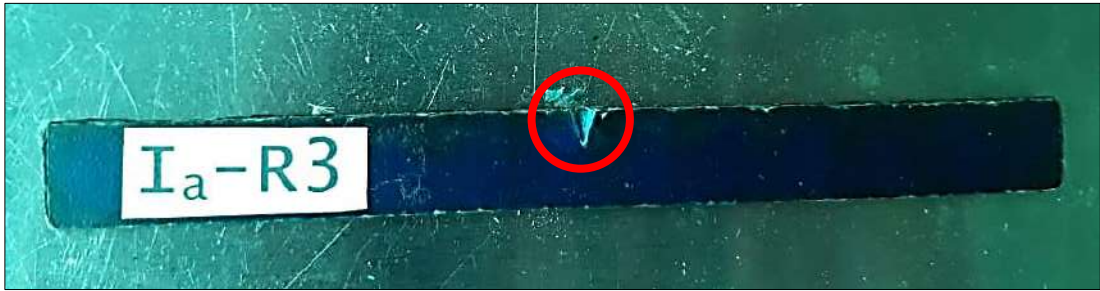
Fotografía 15-3: Probeta entallada para ensayo Impacto Charpy
