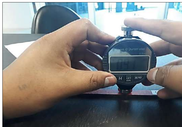
Fotografía 12-3: Determinación de Dureza Shore D en la probeta de ensayo
