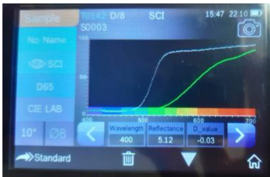
Figura 5-3: Curva de la espectrofotometría de colorantes en Medidor de color PCE-CSM 20 papaya seca
