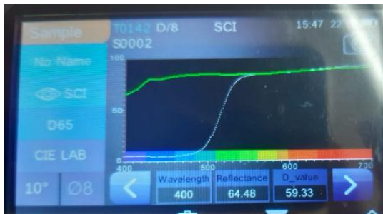
Figura 4-3: Curva de la espectrofotetría del colorante en Medidor de color PCE-CSM 20 papaya húmeda
