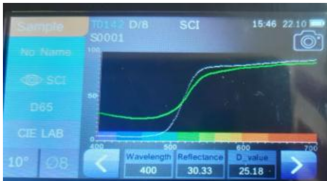
Figura 17-3: Curva de la espectrofotometría de colorantes en Medidor de color PCE-CSM 20 Achiote seco
