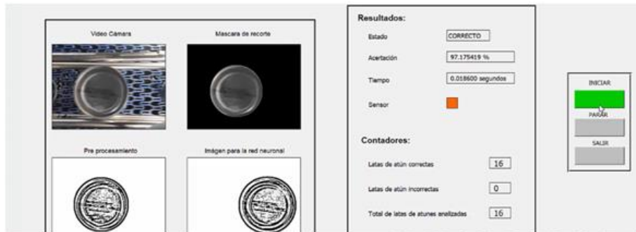
Figura 5-1 Resultado del análisis a las latas de atún con codificación correcta.
