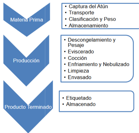
Figura 2-1. Proceso productivo del atún.
