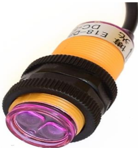
Figura 3-3. Sensor de proximidad fotoeléctrico infrarrojo E18-D80NK
