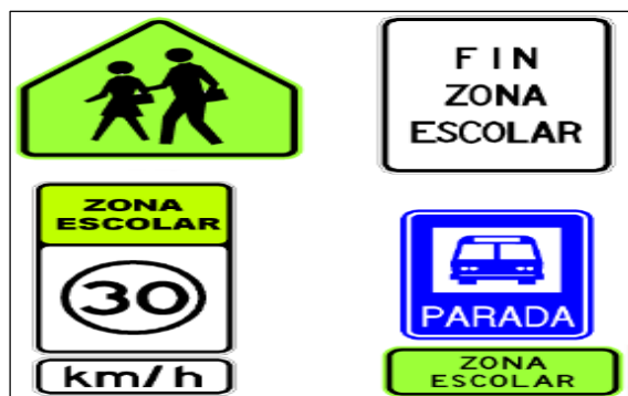
Figura 24-1: Señalización para zonas escolares Fuente: (Instituto Ecuatoriano de Normalización, 2011)
