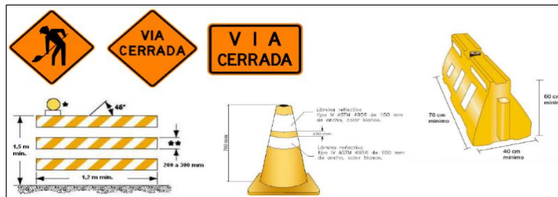
Figura 23-1: Señales para trabajos viales y propósitos especiales Fuente: (Instituto Ecuatoriano de Normalización, 2011)
