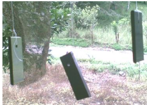
Figura 5.14. Instalación de los cupones.
