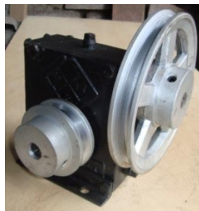
Figura 25. Reductor de velocidades sin fin - corona.
