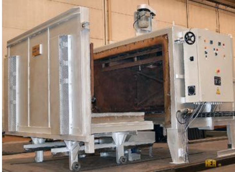
Figura 28. Hornos industriales para tratamientos térmicos con solera móvil.
