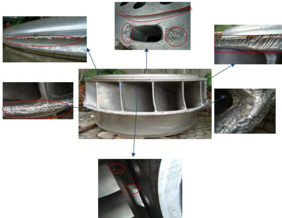
Figura 11. Rodete erosionado de la turbina Francis de la central Agoyán.
