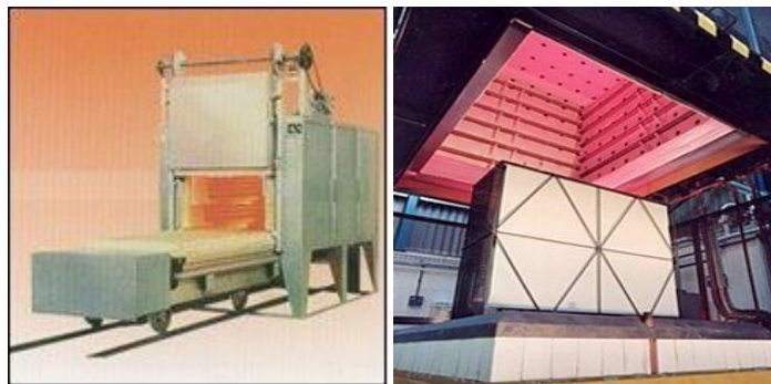
Figura 18. Hornos de solera móvil y fija.
