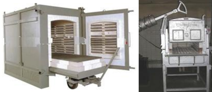
Figura 21. Tipos de puertas para el horno.
