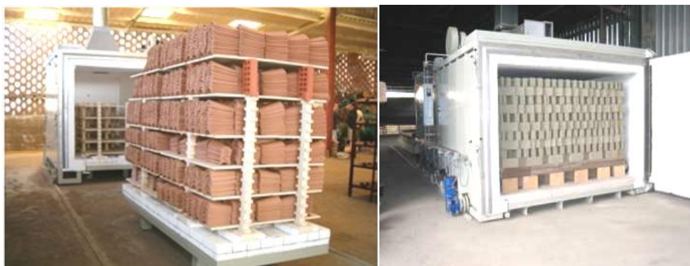
Figura 31. Tipos de hornos con estructura móvil y vagoneta fija en el suelo.
