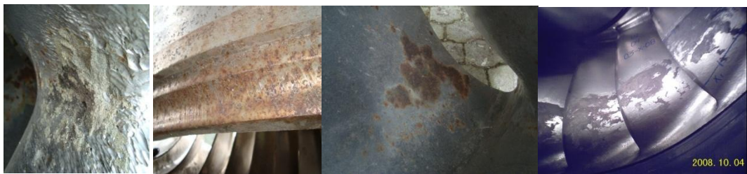
Figura 12. Partes del Rodete corroído de la turbina Francis de la central Agoyán.
