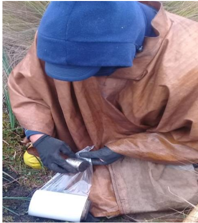
Figura 4-2: Toma de muestras con cilindros
