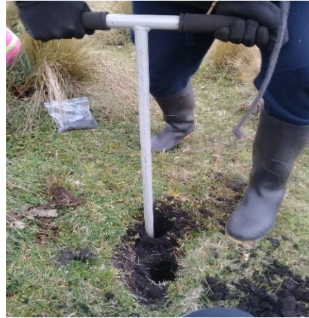
Perforar para tomar la muestra de suelo
