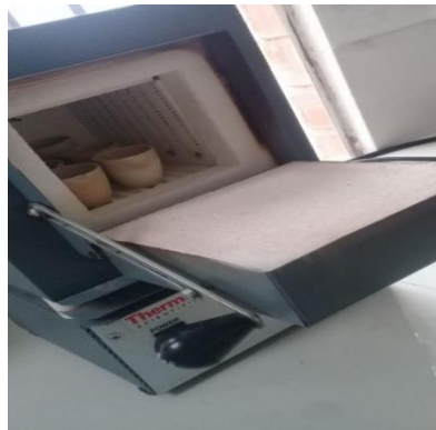
Figura 14-2: Análisis de Materia orgánica, por el método de ignición
