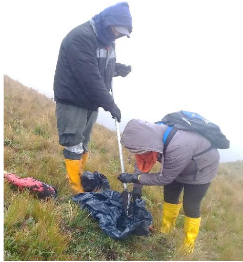
Figura 3-2: Perforación con el barreno y recolección de muestras de suelo
