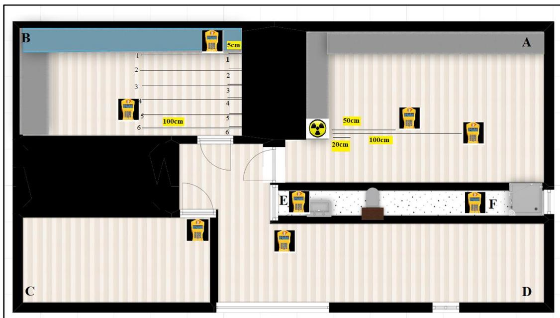
**Figura 1-2.** Esquema del procedimiento de obtención de la tasa de dosis ambiental del bunker
