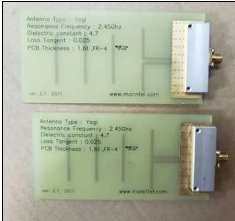
Figura 46-2: Antenas Yagi. Realizado por: Espinoza, Patricio; 2020.
