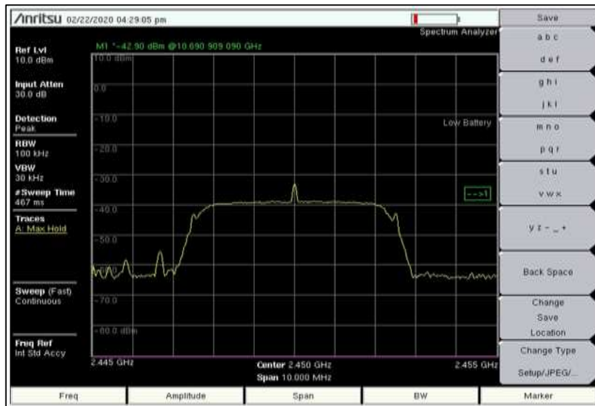
Figura 25-2: Espectro señal chirp, frecuencia de muestreo 80MHz Realizado por: Espinoza, Patricio; 2020.
