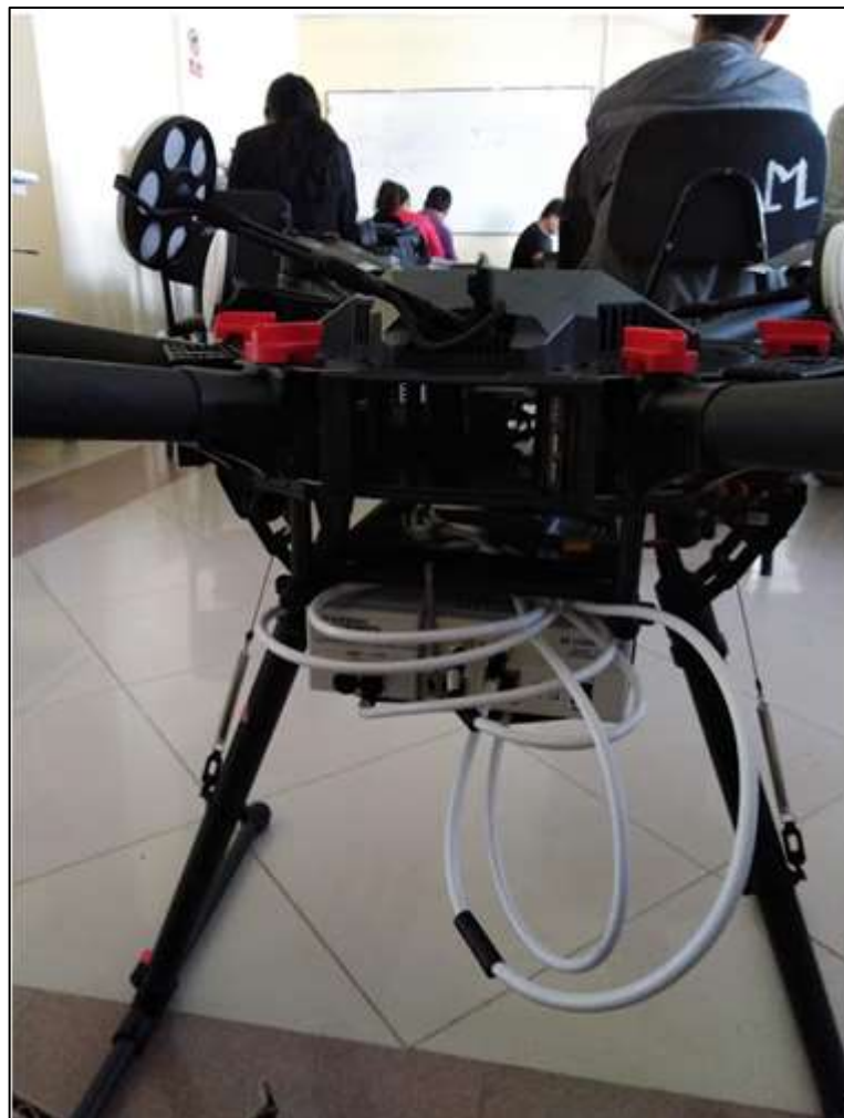
Figura 44-2: USRP-2932 montada en el M600 Realizado por: Espinoza, Patricio; 2020.
