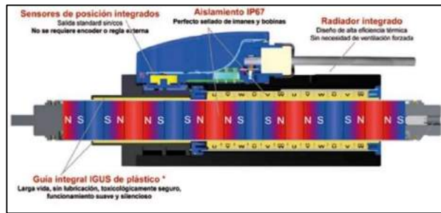
Figura 2-2: Motor electromagnético lineal tubular Fuente: (Saavedra, 2012, p.23).
