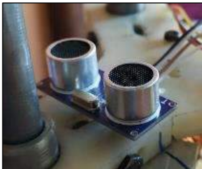
Figura 15-4: Sensor ultrasónico HC-SR04
