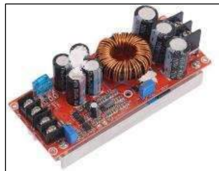
Figura 12-4: Step Up DC-DC 20A 12-83v Fuente: (Aliexpress, 2015)
