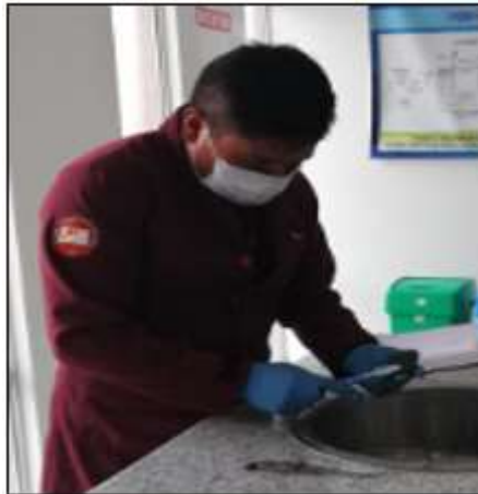
Figura 23-2. Limpieza de probetas con desoxidante
