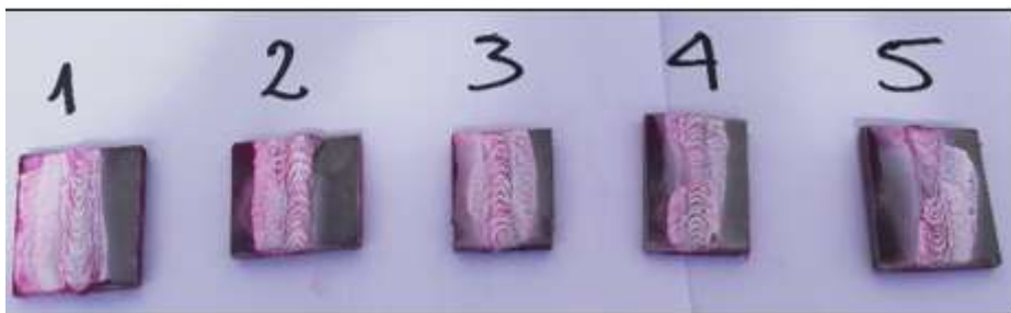
Figura 5-2. Tintas penetrantes colorantes para el acero SA-516 grado 70
