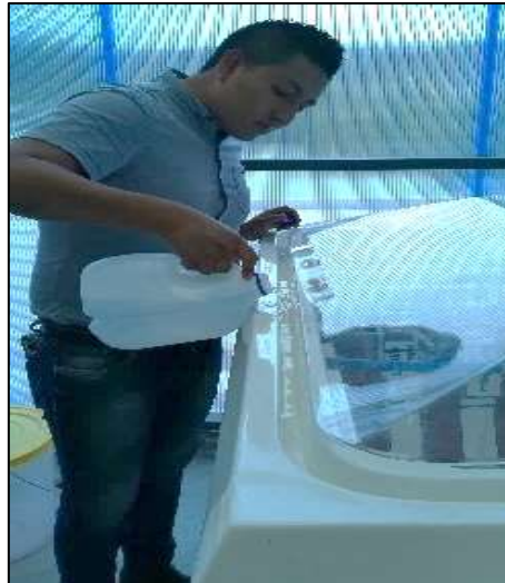
Figura 21-2. Sello hermético de la cámara de niebla salina
