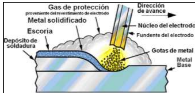
Figura 4-1. Procedimiento de soldadura SMAW
