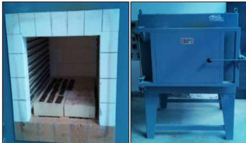
Figura 26-2. Secado de placas mediante horno eléctrico
