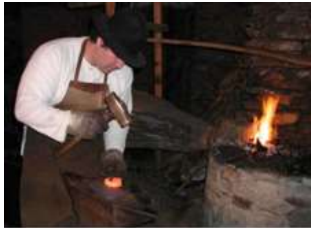
Figura 3-1. Soldadura de Forja
