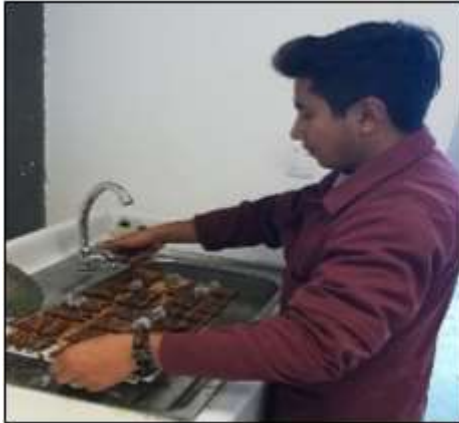
Figura 22-2. Limpieza de probetas con agua de red
