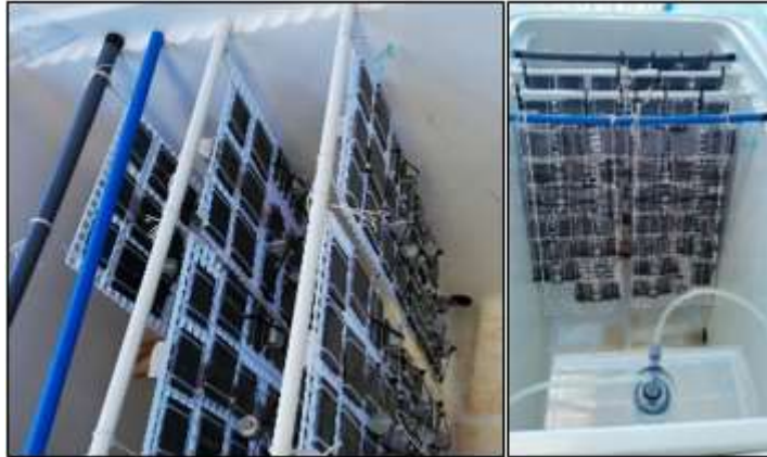
Figura 19-2. Ubicación de las muestras en el interior de la cámara
