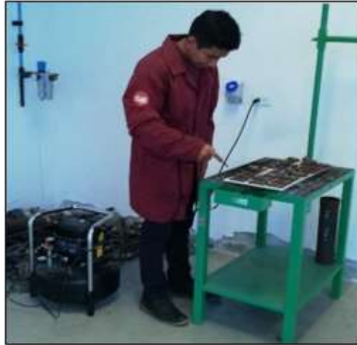
Figura 25-2. Secado de placas mediante aire comprimido
