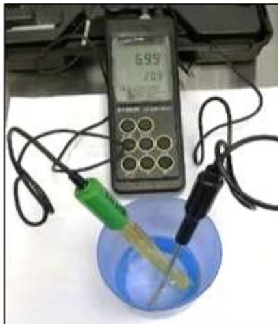
Figura 18-2. Medición del pH de la solución salina
