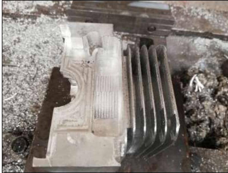
**Figura 36-3.** Block mecanizado
