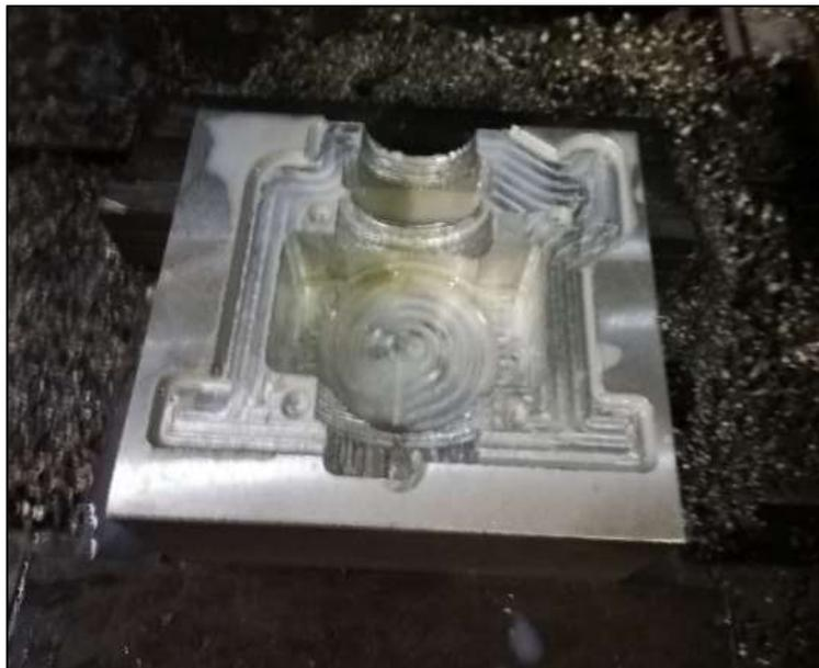
**Figura 35-3.** Mecanización de cara 1
