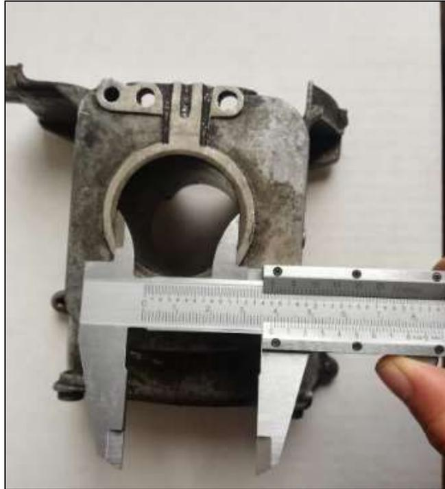
**Figura 2-3.** Medición del modelo.
