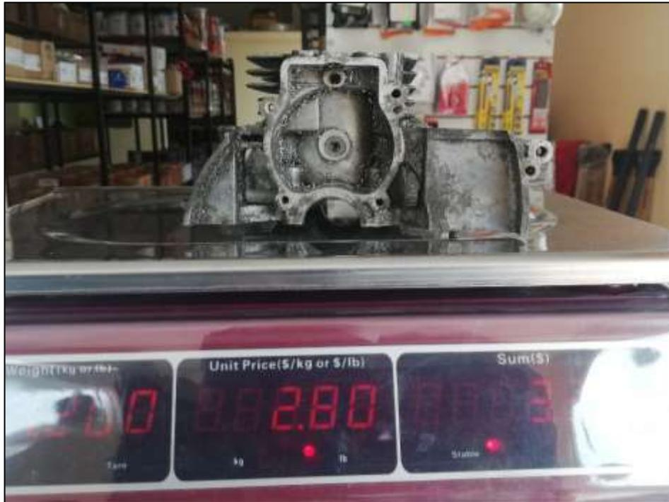
**Figura 39-3.** Peso del bloque del motor de la podadora Poulan Pro PR650RWD.
