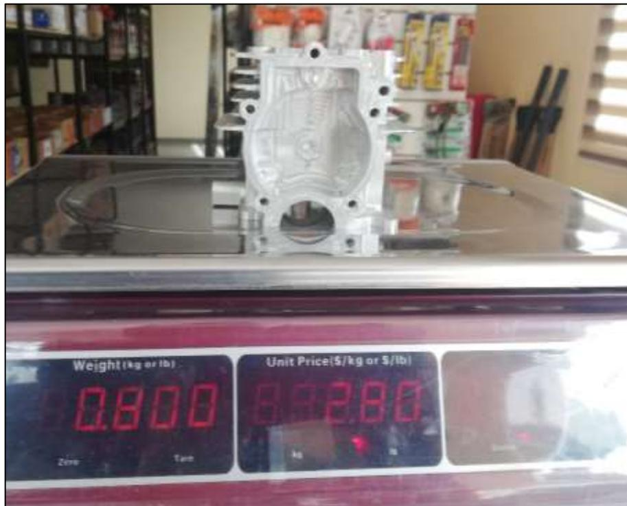
**Figura 38-3.** Peso del prototipo del bloque del motor
