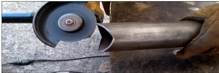
**Figura 9-4.** Corte de la boca de pescado.
