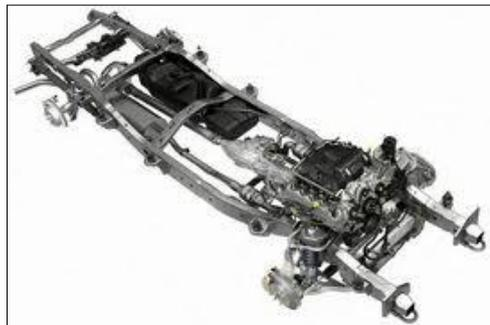
**Figura 3-2.** Bastidor de tipo escalera.
