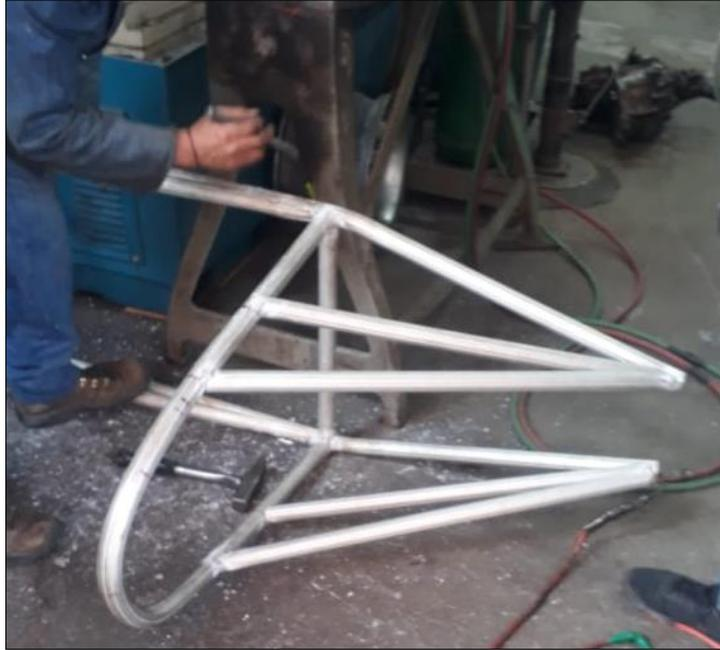
**Figura 13-4.** Proceso de soldadura del mamparo.
