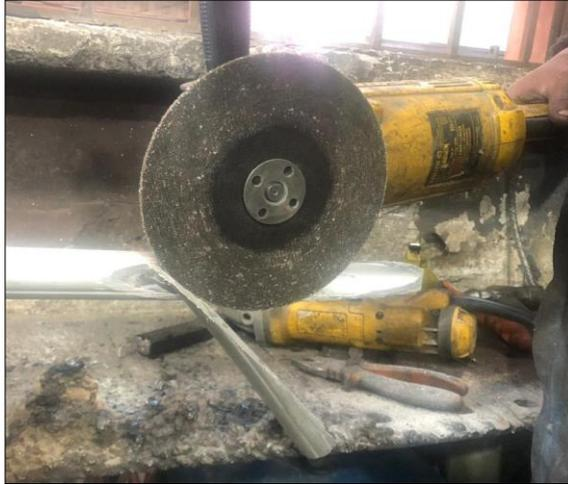
**Figura 11-4.** Cortando el tubo según el ángulo de inclinación
