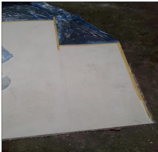
**Figura 17-4.** La mezcla de fibra de vidrio sobre el molde.
