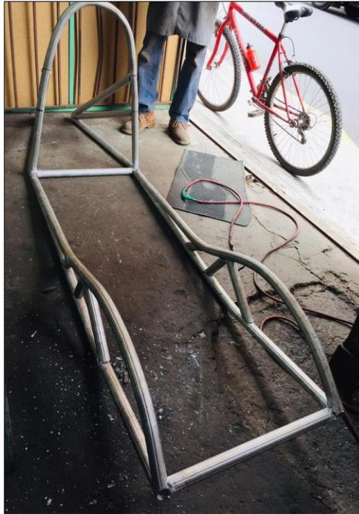
**Figura 15-4.** Chasis terminado, vista isométrica.
