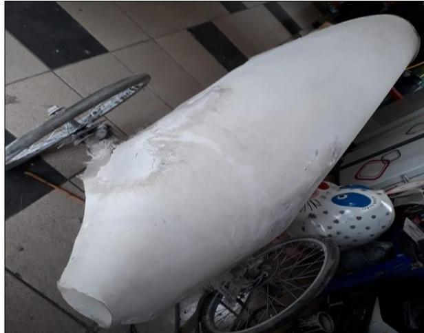
**Figura 21-3.** Chasis cubierto completamente con la fibra de vidrio.
