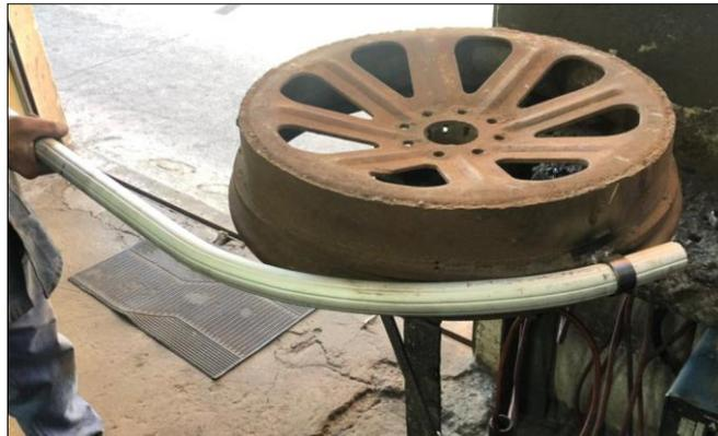
**Figura 5-4.** Doblando la sección del casco del piloto.
