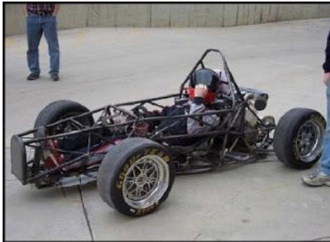
**Figura 5-2.** Bastidor tubular.
