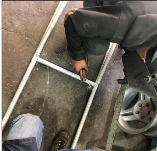
**Figura 12-4.** Proceso de soldadura de los tubos.
