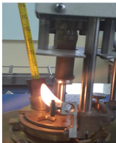
Figura 17-2. Aplicación llama de prueba
