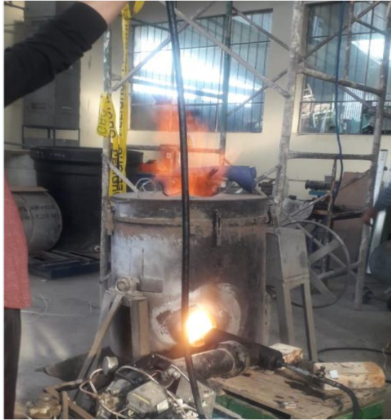
Figura 25-2. Abastecimiento de combustible al horno.
