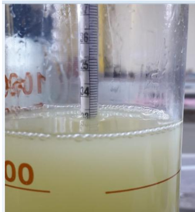
Figura 14-2. Medición escala de temperatura en hidrómetro.
