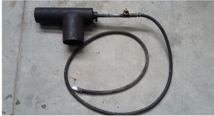
Figura 23-2. Quemador industrial y bomba de combustible.
