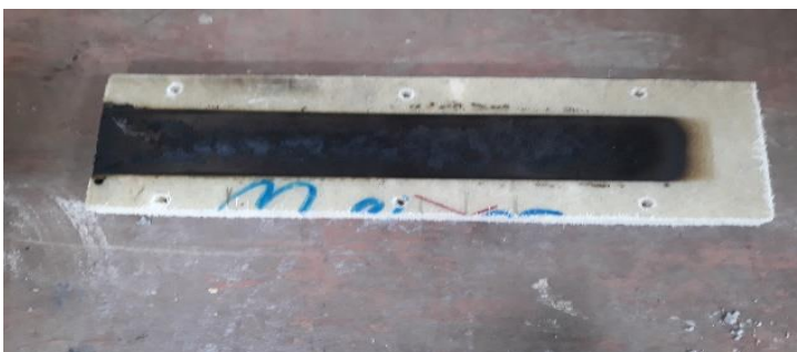
Figura 11-3. Probeta 4 después del ensayo de inflamabilidad
