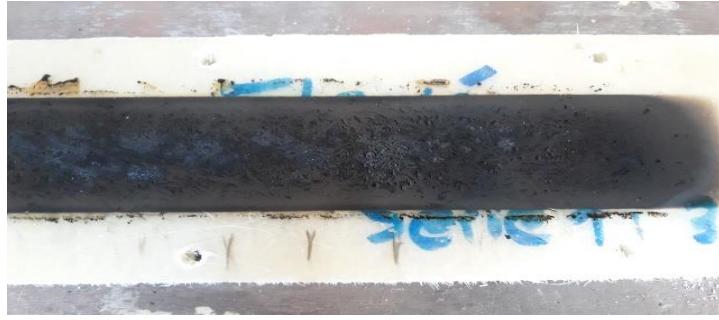
Figura 8-3. Probeta 1 después del ensayo de inflamabilidad
