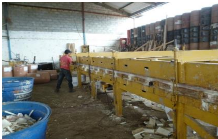
Figura 20-1. Prensa superior hermetizando ambas láminas
