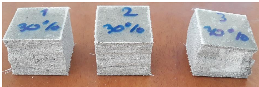
Figura 3-3. Probetas después del ensayo de compresión plana, serie 3
