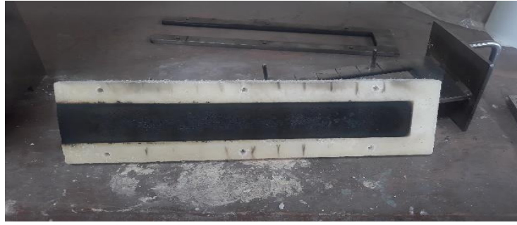
Figura 12-3. Probeta 5 después del ensayo de inflamabilidad
