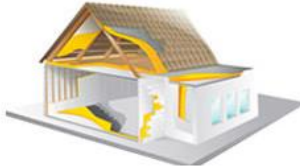
Figura 9-1. Sistema de aislamiento
