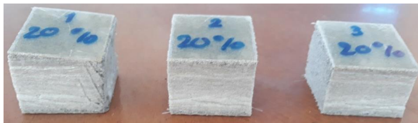
Figura 2-3. Probetas después del ensayo de compresión plana, serie 2
