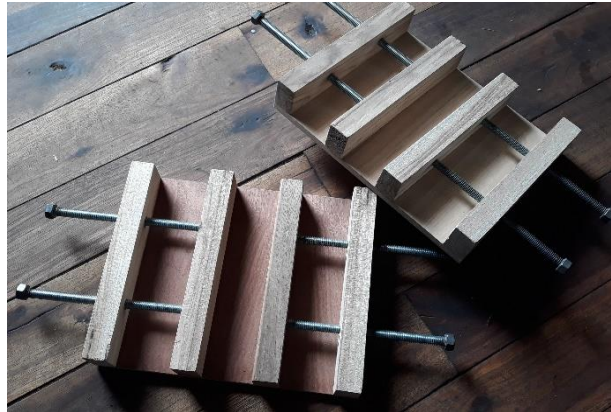
Figura 7-2. Soportes laterales (utillajes)
