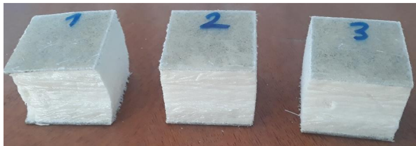
Figura 1-3. Probetas después del ensayo de compresión plana, serie 1
