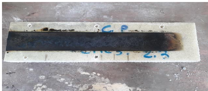
Figura 10-3. Probeta 3 después del ensayo de inflamabilidad
