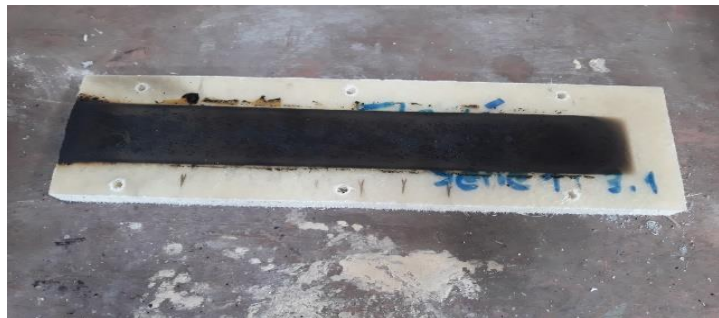
Figura 9-3. Probeta 2 después del ensayo de inflamabilidad
