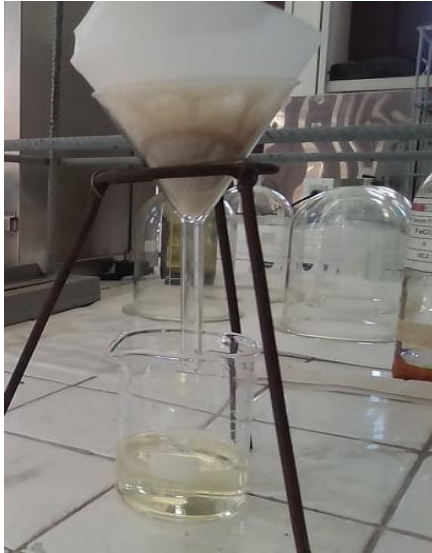
Filtración de cenizas totales para la obtención de cenizas insolubles en ácido.
