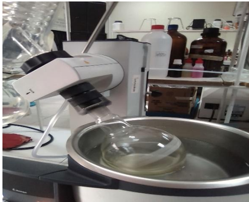
Concentración del extracto bruto en el rotavapor a presión reducida a 60°C
