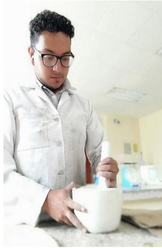
Triturado de las muestras para tamizarlas
