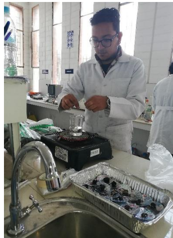
Sumergión de terrones en parafina caliente para determinar la densidad aparente
