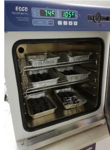
Secado de terrones en estufa para determinación de humedad
