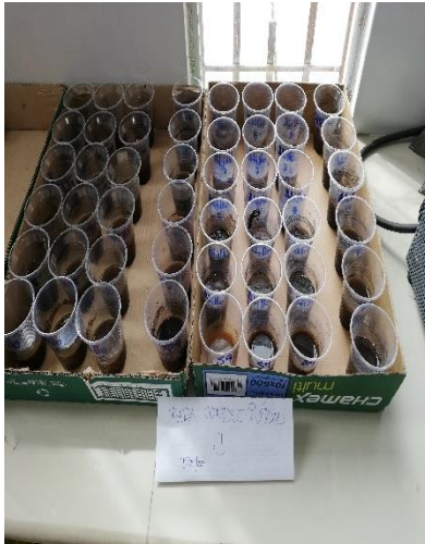
Preparación de muestras para medición de CE
