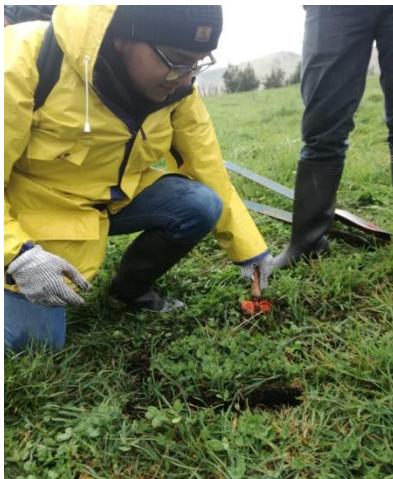
Limpieza del suelo para extracción de la muestra
