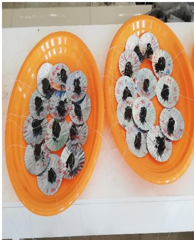
Preparación de terrones para sumergirlos en parafina
