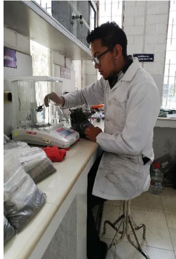
Peso de suelo para medición de pH
