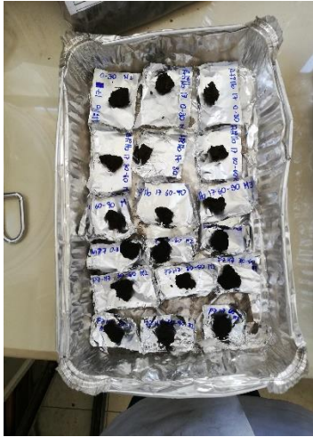
Preparación de terrones para determinación de humedad
