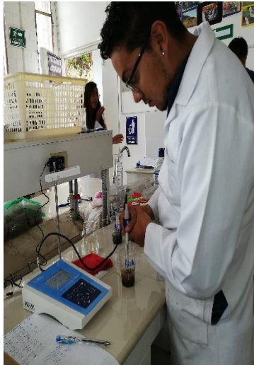
Análisis de Conductividad Eléctrica
