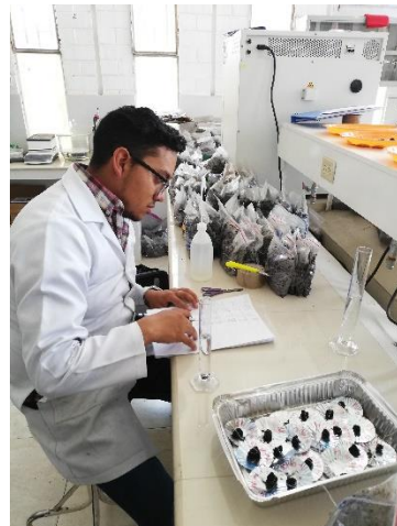
Determinación de la densidad aparente
