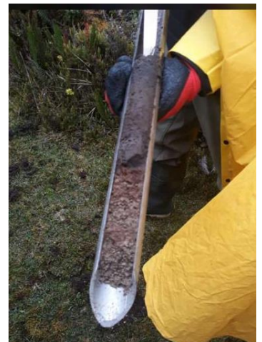
Obtención de muestra de suelo
