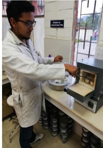
Ingreso de crisoles para determinar MO
