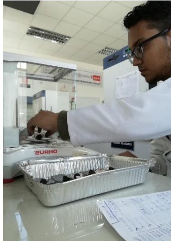
Pesado de terrones para determinación de humedad
